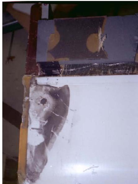
図 11 モールドセル内の絶縁破壊
