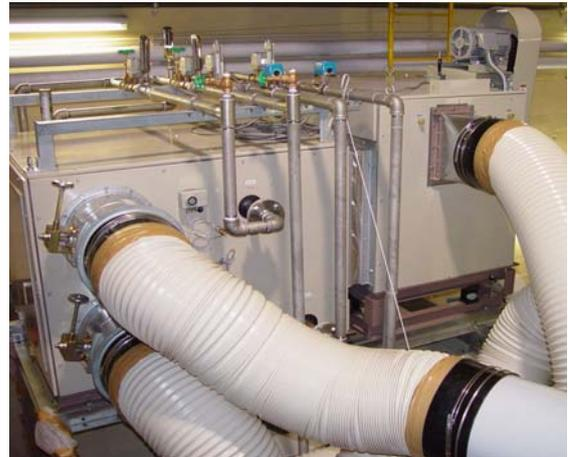
図 4-1 空気冷却装置
