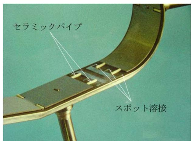
写真2 電極取り付け部分
