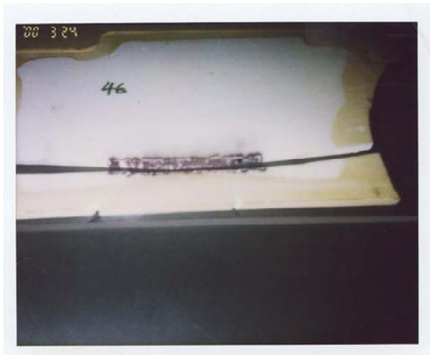
図 17 収縮により割れたセラミックス板
