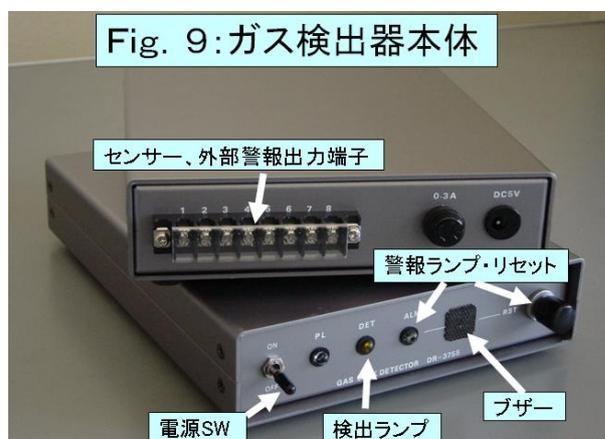
Fig. 9はガス検出器本体で、本装置の検出部以外を納
