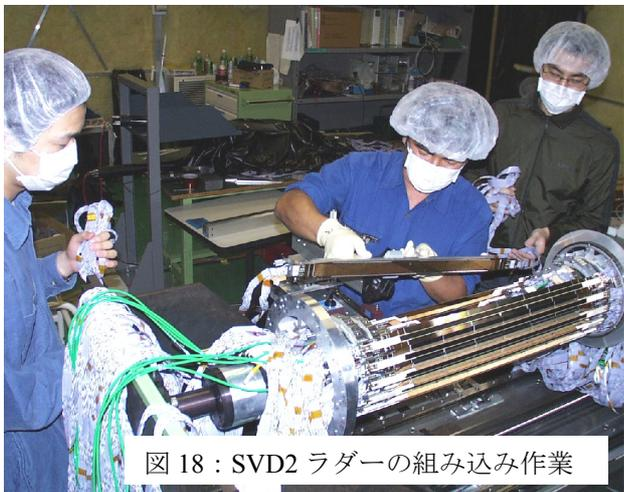
図 18 : SVD2 ラダーの組み込み作業
