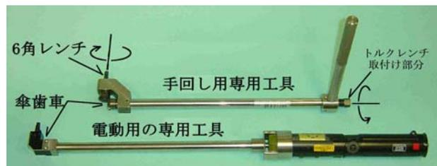
写真4 位置モニター取付専用工具
