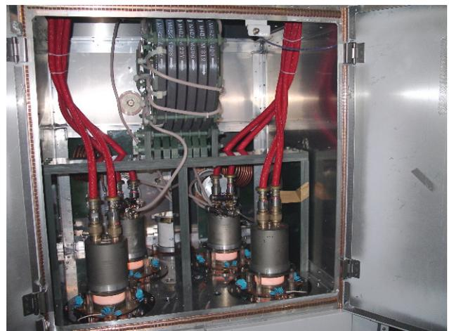
図 5-1 電力増幅器内部・出力トランス
