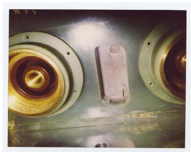
図 8 モールド内の亀裂 (前面)
