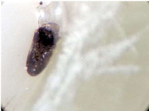
図 13 絶縁破壊部にあったボイド
