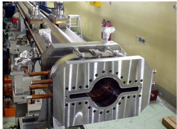
Fig. 22 リングに設置したビームダクト(左)とベローズチェンバー (右)
