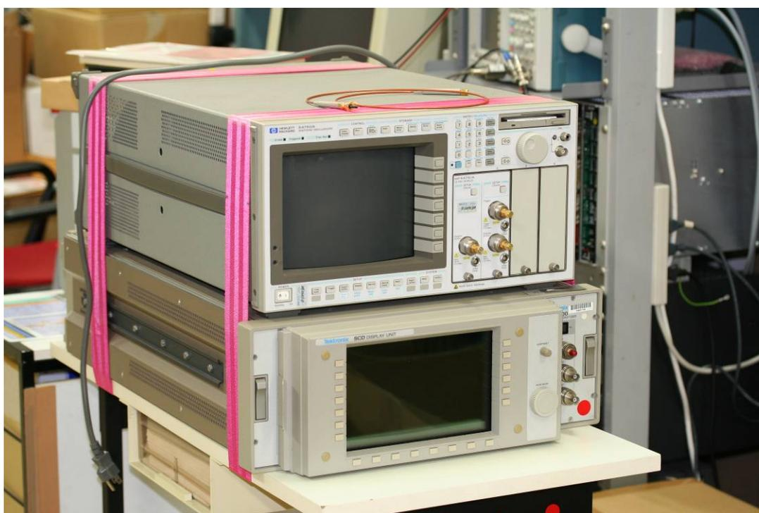
写真4 20GHz帯域サンプリングオシロスコープ(上)と
