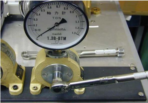
Fig. 7 軸力測定
