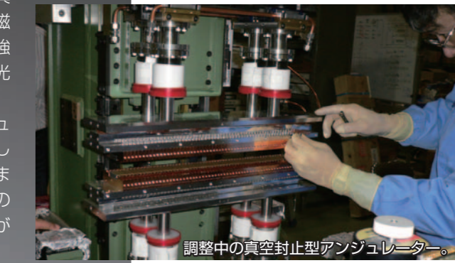
調整中の真空封止型アンジュレーター。
