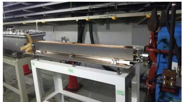
図 4-3 設置された 2 つのセプタム電磁石 (SI, SII)。SI は真空チャンバー内に組み込まれている。
