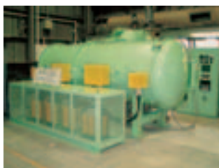
超伝導空洞用 3m 真空炉
