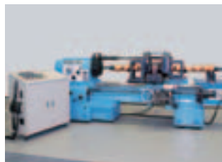
特殊加工機及び加工法の開発研究 「超伝導シームレス空洞のしぼり加工機」
