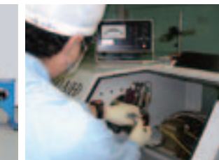
超精密加工による常伝導 X バンド加速管用ディスクのサブミクロン芯出し作業
