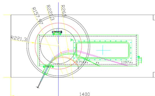
この演習では荷電粒子の軌道と運動量分析法の基礎について学習します。円形磁極を持つ電磁石を用いたスペクトログラフの場合、比較的簡単な幾何光学的取り扱いをすることで、荷電粒子の軌道と運動量の良い相関が得られることがわかっています。原子核のなかには、弱い相互作用で壊変（ベータ崩壊）して、電子
