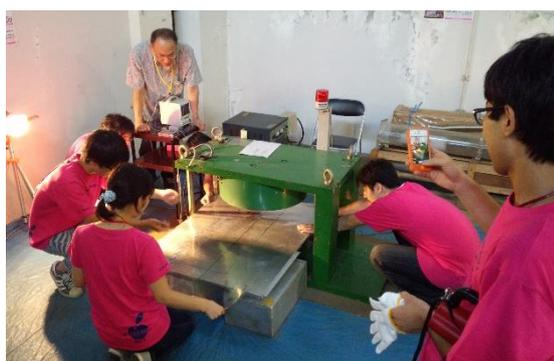
(ベータ線)を放出するものがあります。この円形磁極スペクトログラフを用いて、ベータ線のエネルギースペクトル（エネルギー分布）の測定を行います。スペクトログラフの軌道計算、真空槽の設置と排気運転、焦点検出器の設置、電磁石の運転、磁場測定、ベータ線スペクトルのデータ解析と評価といった、実際の素粒子原子核実験研究と同様の手順を一通り体験できます。
