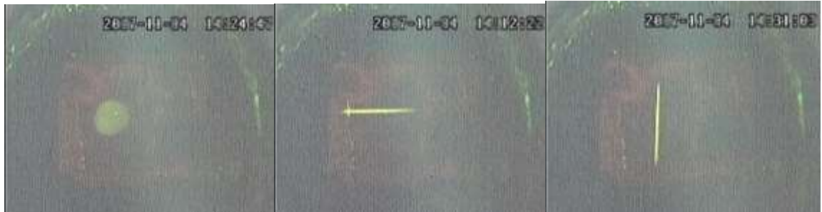
Fig 2 : スクリーン上の電子ビームの像
