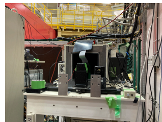
図 3 左が PMT にガラスとシンチレータを張り付けたもの、右がそれを暗幕で覆ってビームライン上に置いた様子 (真ん中にあるのが PMT)
