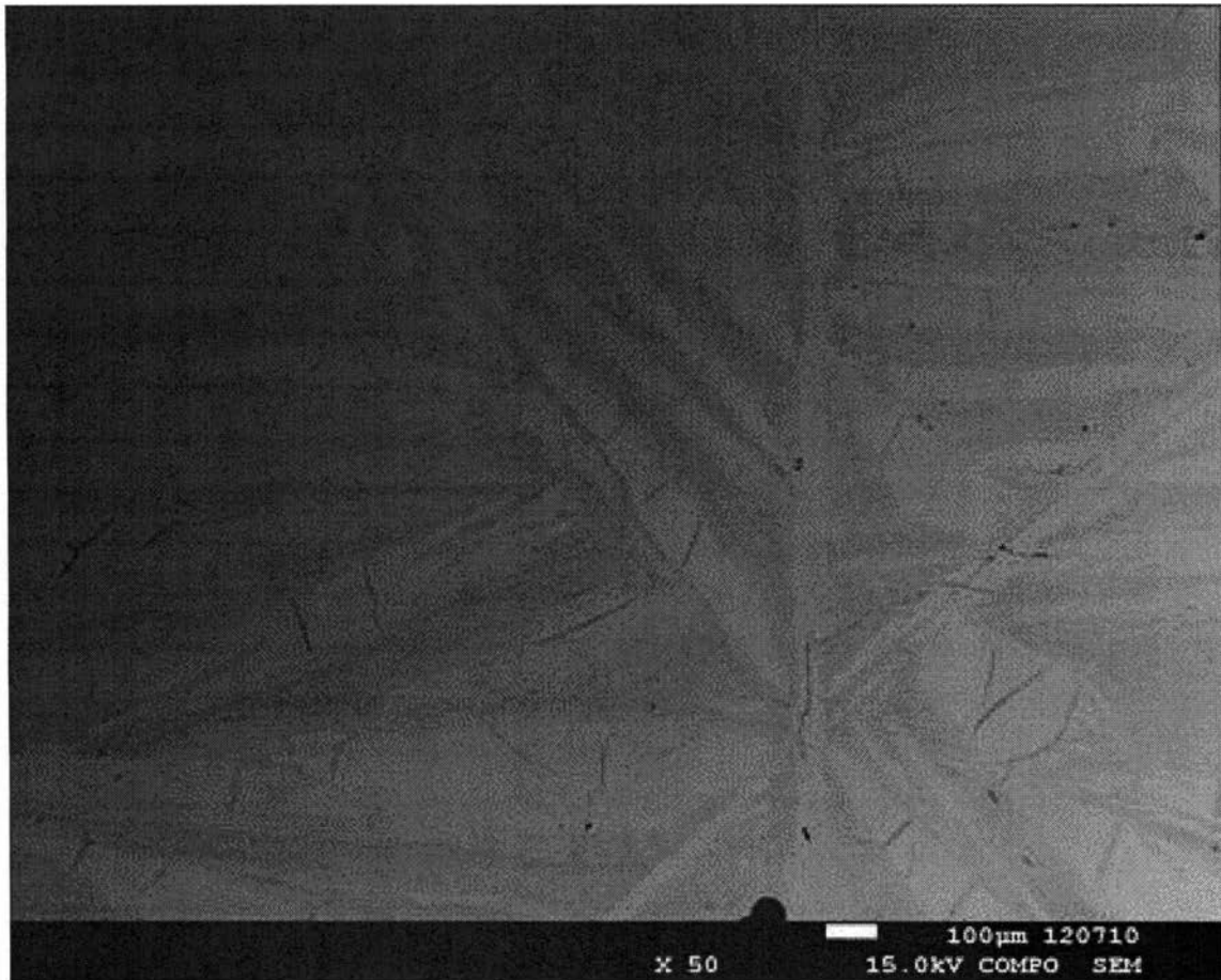
写真 1 Ir-14wt%Ce 合金の凝固組織 500 \mu ~ 1mm におよぶ粗大な結晶粒が発生
