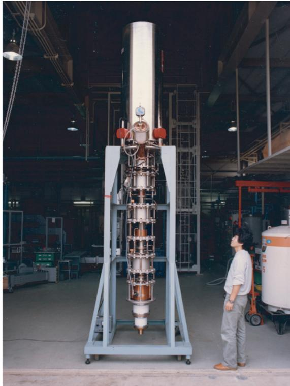
図2 トリスタン・KEKB用1.2MW連続波クライストロンの外観。機械構造が改良され、空洞も全て内蔵型になっているが、出力セラミック窓は未だ円筒型のもの。右は竹内保直。撮影は1984年ごろ。
