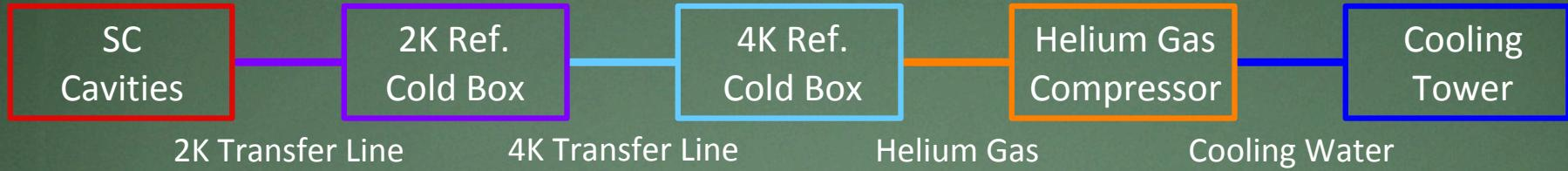
1. ヘリウムガスを圧縮機で圧縮( $\sim 1.7 \text{ MPa}$ )
