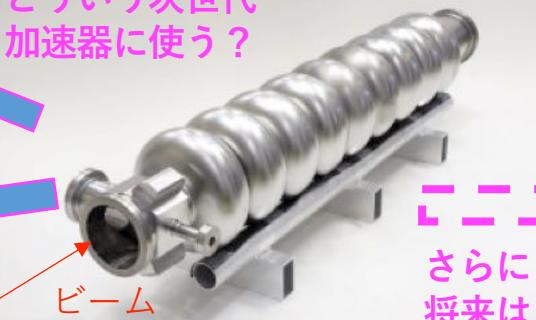
1.3 GHzニオブ(Nb)製超伝導空洞
