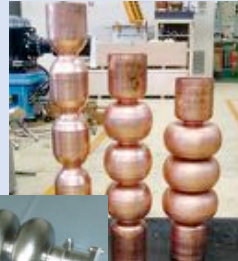
液圧成型によるシームレス空洞
