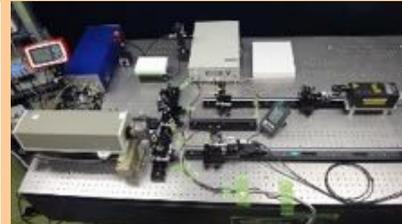
素粒子原子核研究所のミュオン精密測定研究グループと協力して、g-2/EDM実験用陽電子飛跡検出器のアライメントモニターの開発を行っています。また、シリコン飛跡検出器の精密位置決め組立装置の開発も行っています。
