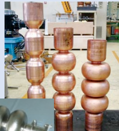
液圧成型によるシームレス空洞
