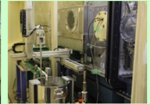
Heチャンバーに対応した 試料交換システムの開発
