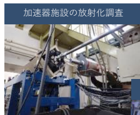
電磁石の放射化イメージング
