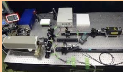
ファイバ導入型の絶対測長干渉計を用いた測長網 (左) 基準干渉計を用いた光周波数コムパルス間隔校正 (右)
