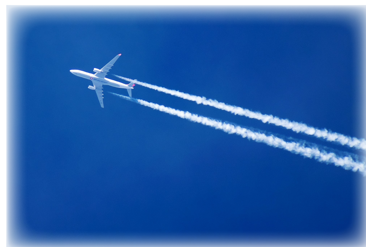
【図 1-2】飛行機雲は、上空(高度約 1 万メートル)の気温が非常に低く(マイナス40度以下)、エンジンの排気ガスに含まれる水蒸気が冷やされて氷の粒となり発生します。
