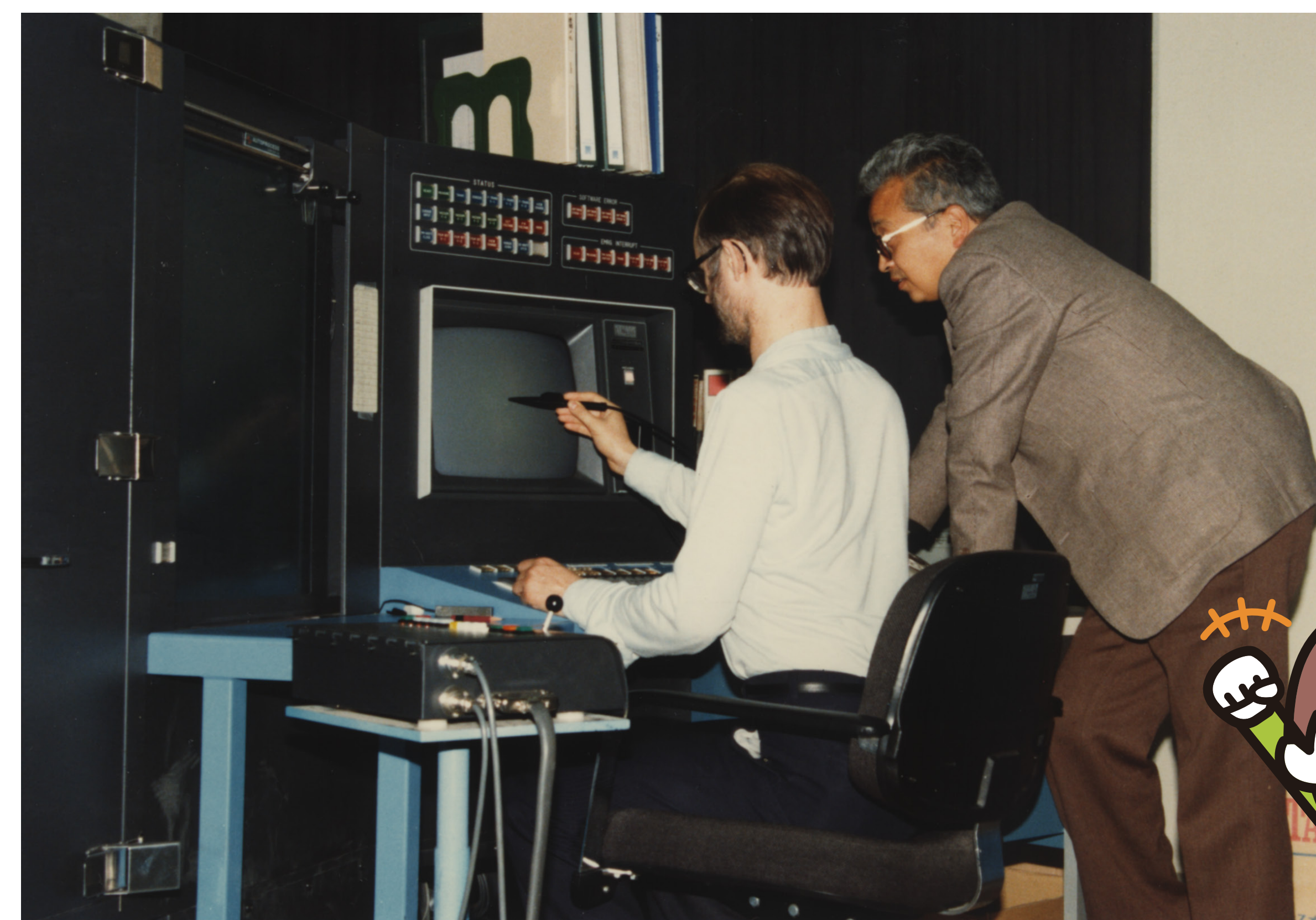
【図3-3】KEK泡箱写真自動解析装置 KAMA (KEK Automatic Measuring Apparatus) (1981年撮影) KEK史料室所蔵資料
