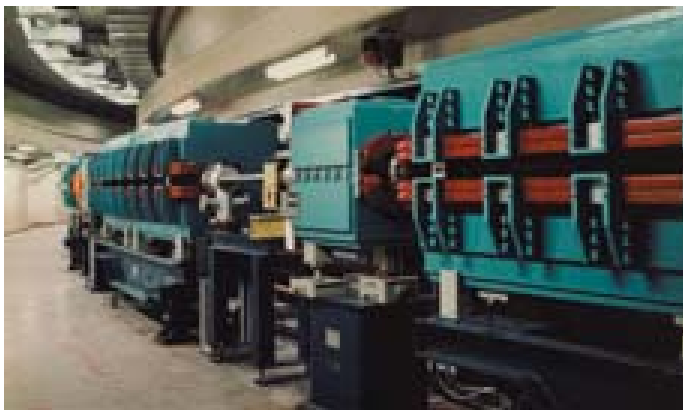
図1 KEKに作られた12GeV陽子シンクロトロンのメインリング
