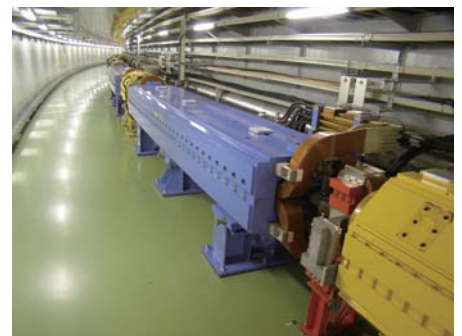
図3 MRと呼ばれるシンクロトロン (エネルギー 50 GeV) ※現在 30 GeV で運転中
