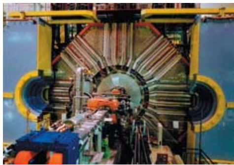
図3 KEKB内に設置されたBelle検出器
