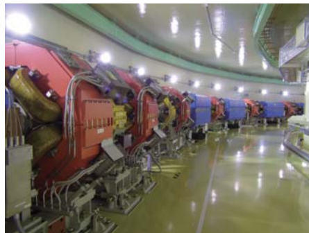
図2 RCSと呼ばれるシンクロトロン (エネルギー 3 GeV)
