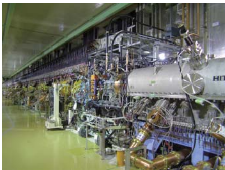
図1 リニアック(エネルギー 400 MeV) ※現在 181 MeV で運転中
