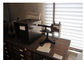
【資料：ローリッツェン型検電器】
