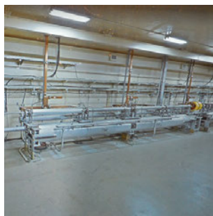
加速管と導波管
