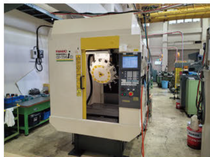
使用するマシニングセンタ (FANUC α-T14iD)
