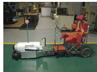
図7 完成した牽引自走車
