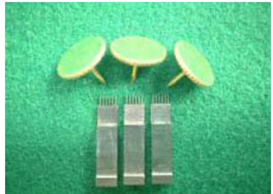
図 1 コアピンの形状と寸法
