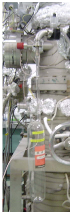
図5 . 超高真空内にガスを導入するための ジョイント
