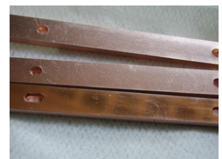
熱処理後上 2 枚がタフピッチ
