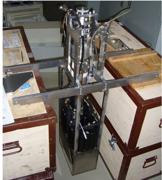
図7 製作した8の字 PWO ユニットの仮組み
