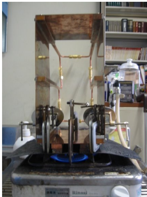
図 16 PWO 冷却板の溶接
