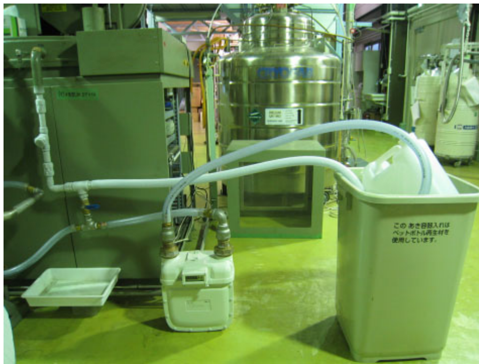
図 11. 窒素ガス流量を量っている様子
