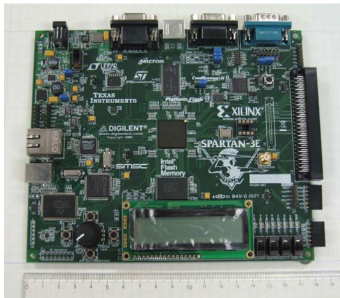
写真1 ハードウェアエミュレータとして利用している Xilinx Starter KIT (評価ボード)。FPGA 内に NEUNET プロトコルでデータをやり取りできるようなプログラムが入っている。
