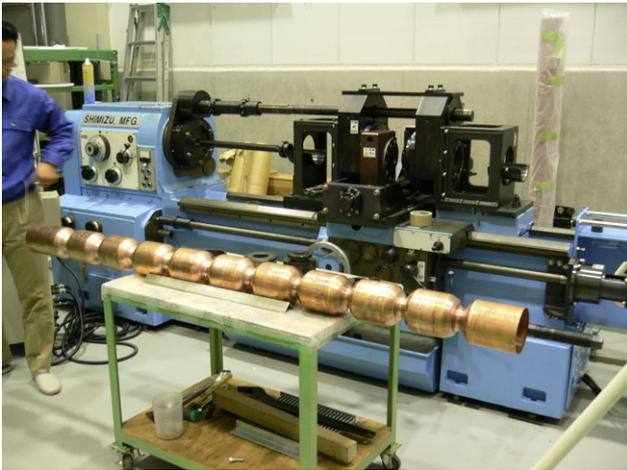
写真3 銅パイプを使ったネッキング加工
