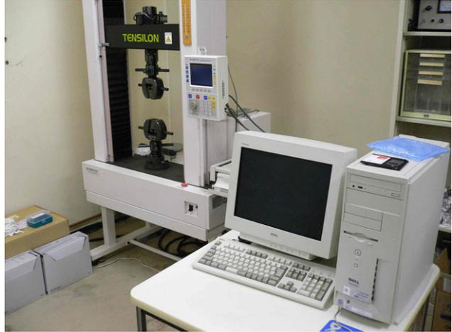
写真 9 引張り試験機 (RTC-1325A)
