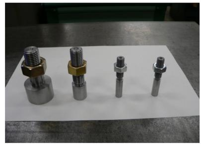
図 12. ねじ切り加工 (M20,M16,M10,M10)
