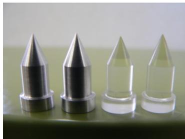
図 15. キャリブレーション用フロート
