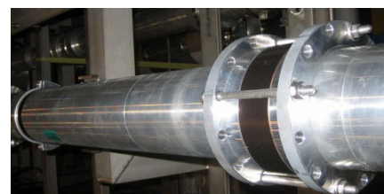
図 4. 上:大気用導波管継手部 下:真空対応用改良継手部
