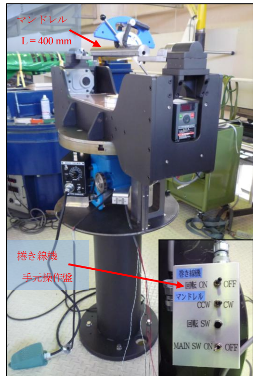
図 8-4 巻き線機操作盤の組込(図 8-5 操作盤)
