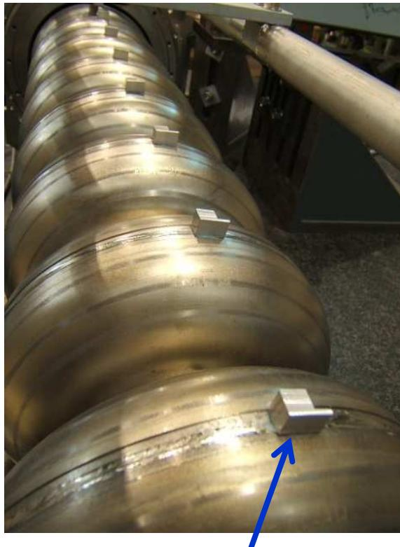
各セルの上にキューブマウンティングワックスで固定
