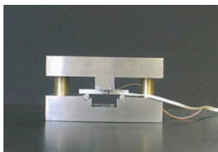
図14 曲げ試験装置
