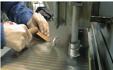
図 6 固定板によるチャッキング
