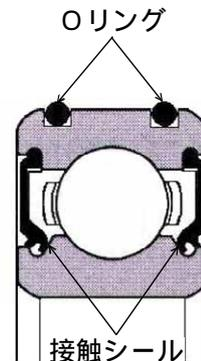
図6. AC6205LLU型ベアリング断面図
