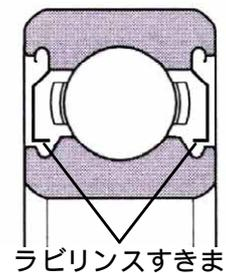
図4. 6205ZZ型ベアリング断面図
