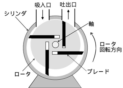
図3. ドライポンプの模式図
