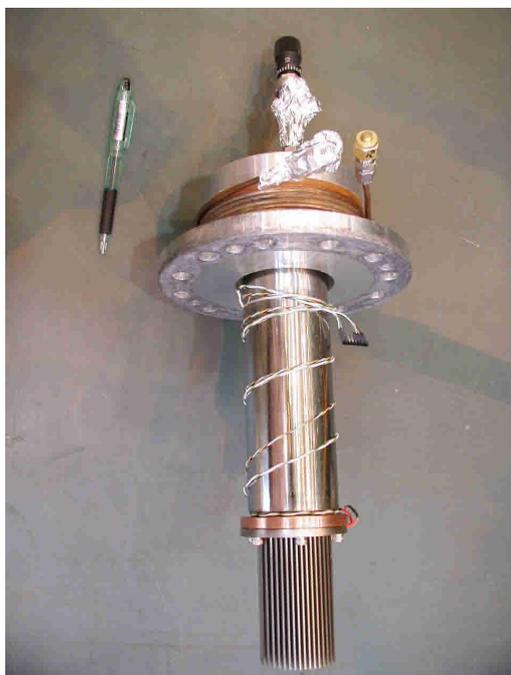
Fig.2 LXe 用パルス管冷凍機
