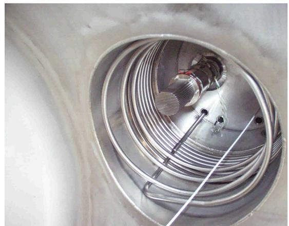
Fig.6 冷凍機と液体窒素冷却チューブ
