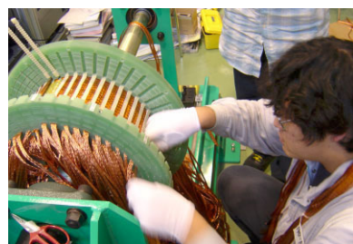
図8 リッツ線挿入風景
