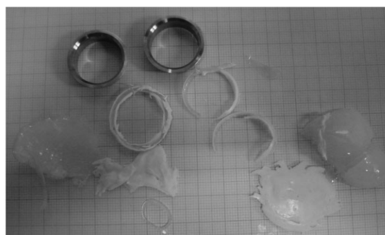
図4 塩化メチレンによるアラルダイトとトールシールの剥離性の調査
