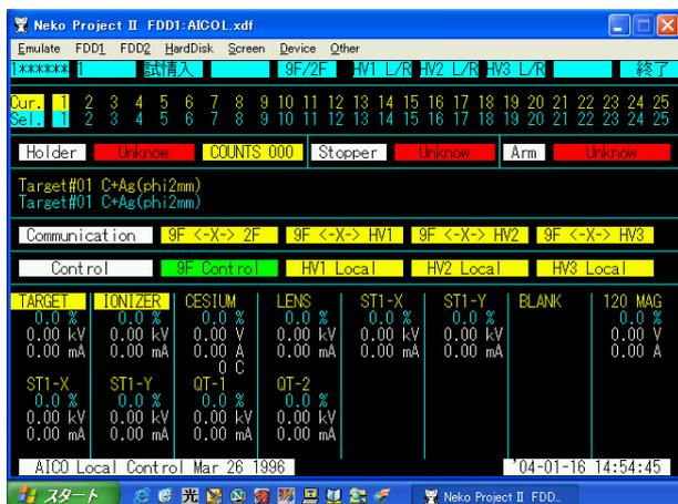
図 7 . np2.exe 上のイオン源試料交換プログラム画面
