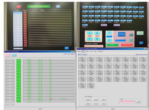
図 1.旧制御系 GUI(上)と新制御系 GUI(下) 左が大型電源 ON/OFF で右が電流値設定
