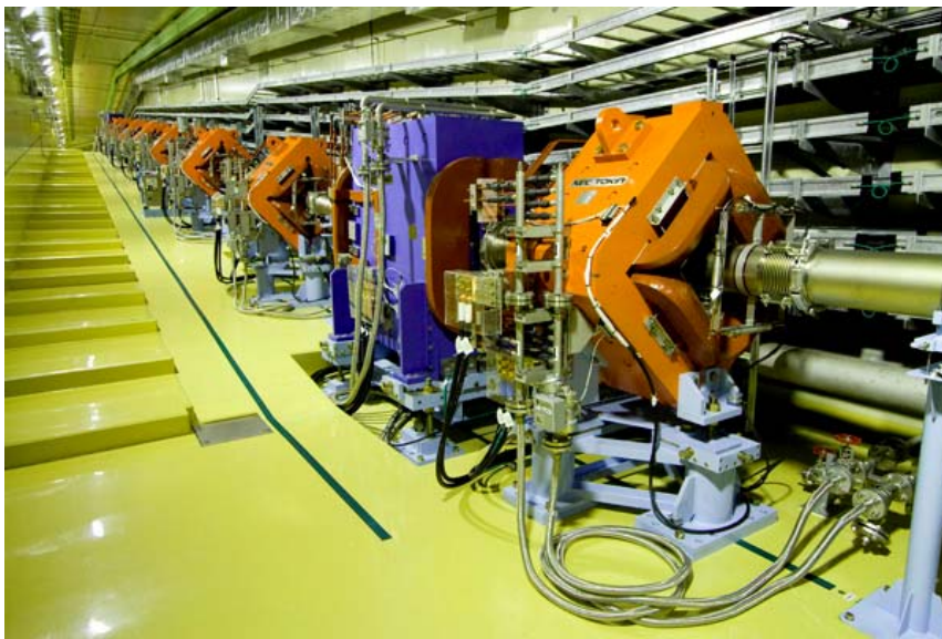
図5 7.5度傾斜部（水平距離：36m 高低差：5m）
