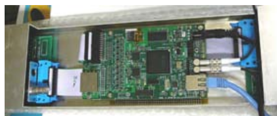
図 1 3 NEUNET08 を PSD 支持箱内に装着
