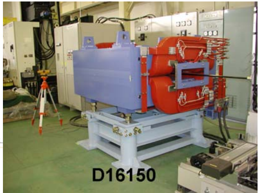
図2 7.5度偏向電磁石の3D解析モデルと磁場測定
