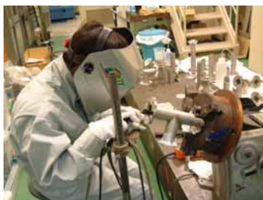
図1 ユニバーサルポジショナーを使用した 溶接作業
