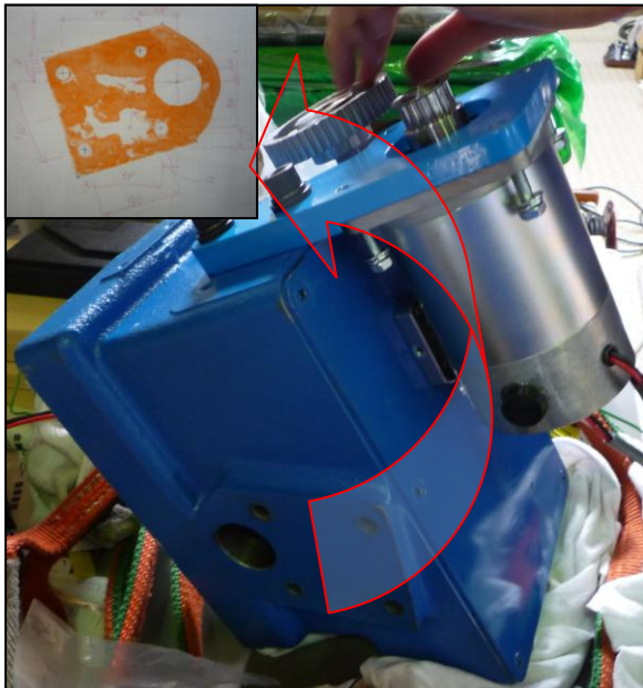
図 8-1 寸法測定(左上図: 光明丹で型取り)
