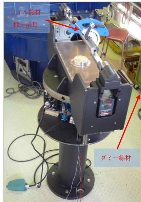
図 9-2 巻き線作業（ダミー線材）
