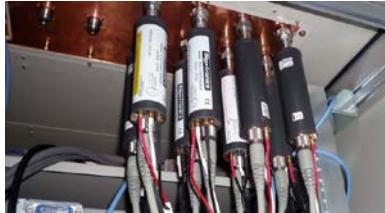
図7 パワーメータとパワーセンサ
