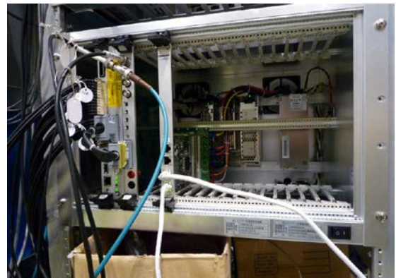
図6 cPCI 34チャンネルモニタ系
