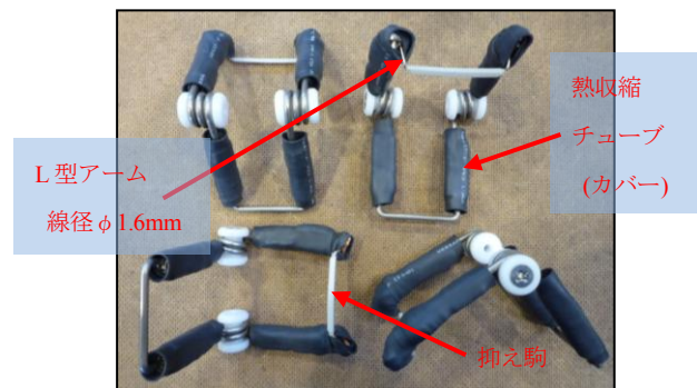
図 4-5 コイル線材抑え治具（4 組）
