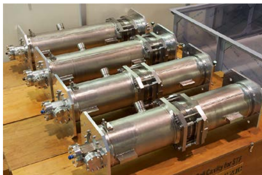
図 1：ILC 用 9 セル超伝導空洞（上）、及びヘリウムジャケットが装着された 9 セル超伝導空洞（下）
