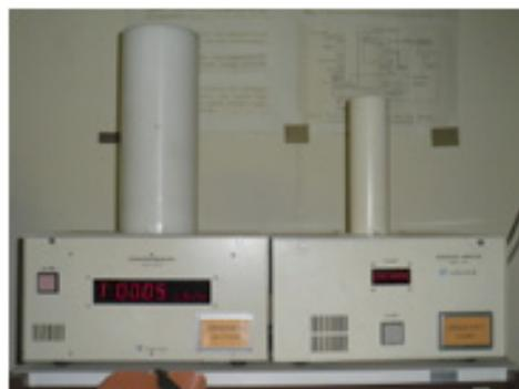
図1：放射線モニター（右：中性子線用、左： $\gamma$ 線用）
