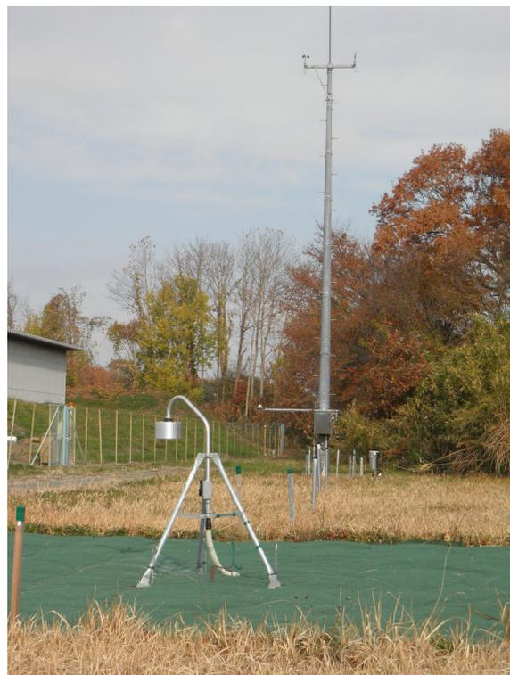
図6：気象観測装置（手前は雷検知器、奥に見えるのは気象観測塔）
