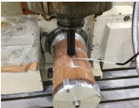
5 軸加工機によるエンドスペーサの加工
