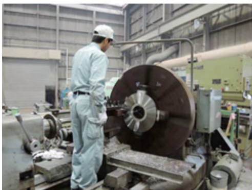
図 5.1.14 超伝導磁石用吊り具の加工風景
