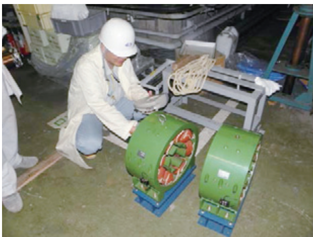
放射化したマグネットの線量測定
