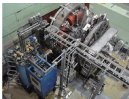
図 5.1.19 ハドロン実験施設のビームラインに設置された超伝導トロイダル磁石
