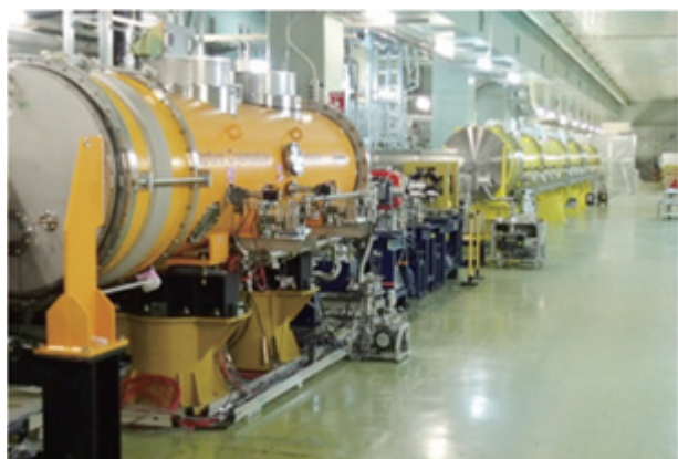
STFに設置された超伝導空洞
