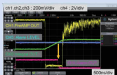
警報出力動作確認
