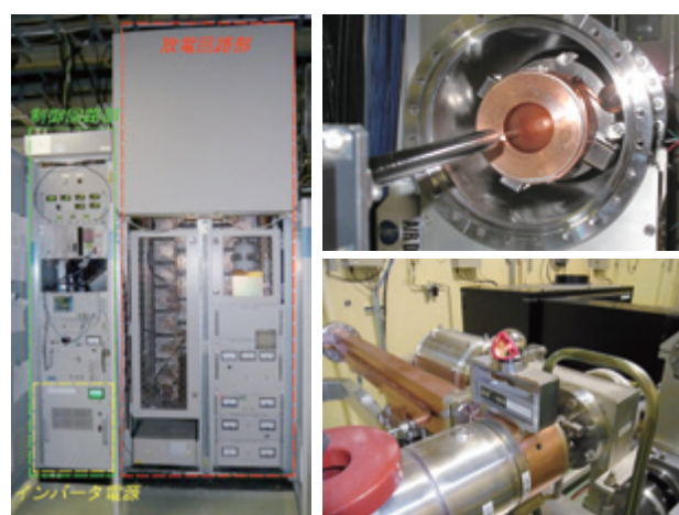
約 1/3 に小型化したクライストロンパルス電源 (左) 磁場測定中の陽電子収束用新型パルス電磁石 (右上) 精密アライメント中の加速管 (右下)
