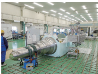
完成間近の QCS マグネット全景
