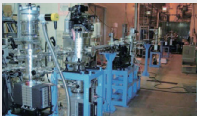
図 3.3 筆者らが建設した真空紫外・軟 X 線ビームライン（BL-28 の例）
