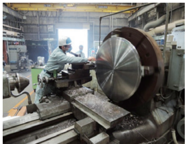
正面旋盤によるフランジの加工
