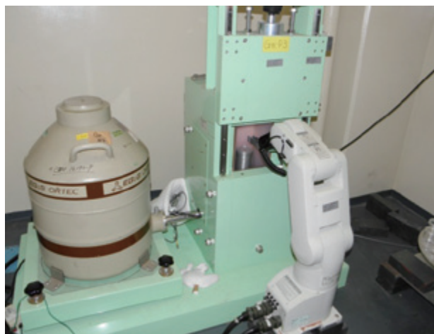
ロボットアームによる自動測定装置
