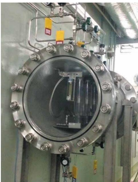
図8 フィルター装置 正面
