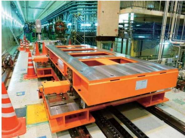
図 10 SuperKEKB 用移動架台完成図
