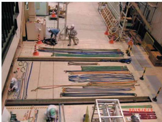
図6：吊具点検の作業
