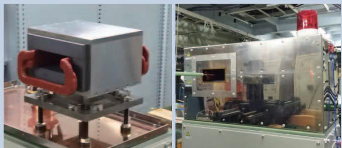
図 2 キッカー電磁石本体（左）及びキッカー電磁石磁場測定の様子（右）（キッカー電磁石はシールドボックス内に覆われている）
