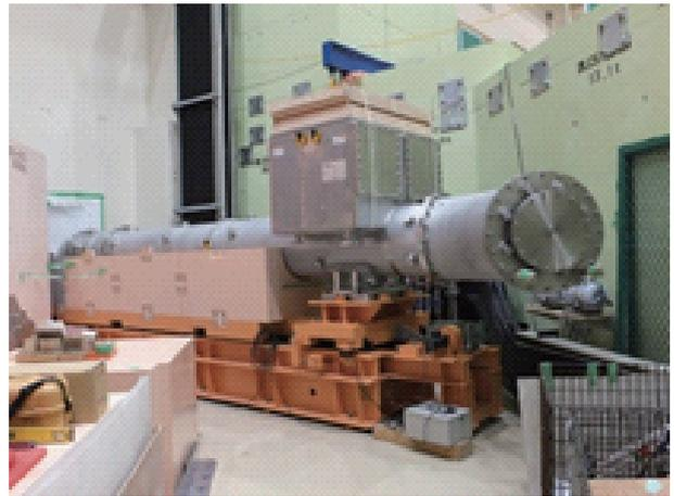
図5 超伝導湾曲ソレノイド電磁石のインストールの様子
