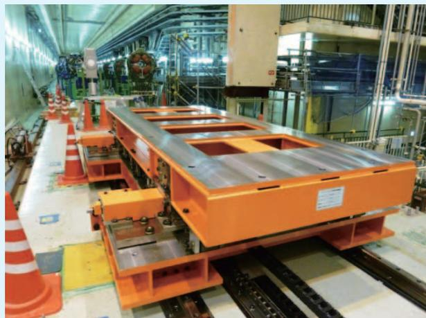
図 5.1.5 SuperKEKB 用移動架台完成図
