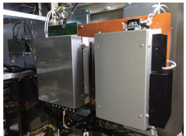
開発した新電源の高精度電流制御フィードバック部の恒温槽
