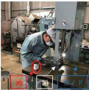
図 2：コンタマシン加工時の様子
