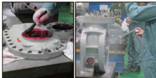
図5：浸透探傷試験の様子
