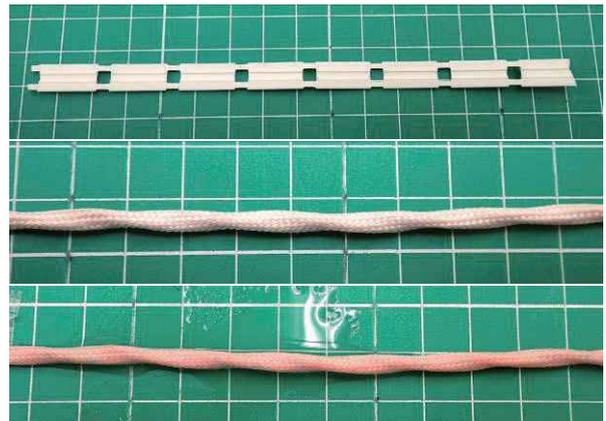
図 4：漏水検知帯(上：F03-16PE、中：F03-16SFC(乾燥時)、下：F03-16SFC(漏水検知時))
