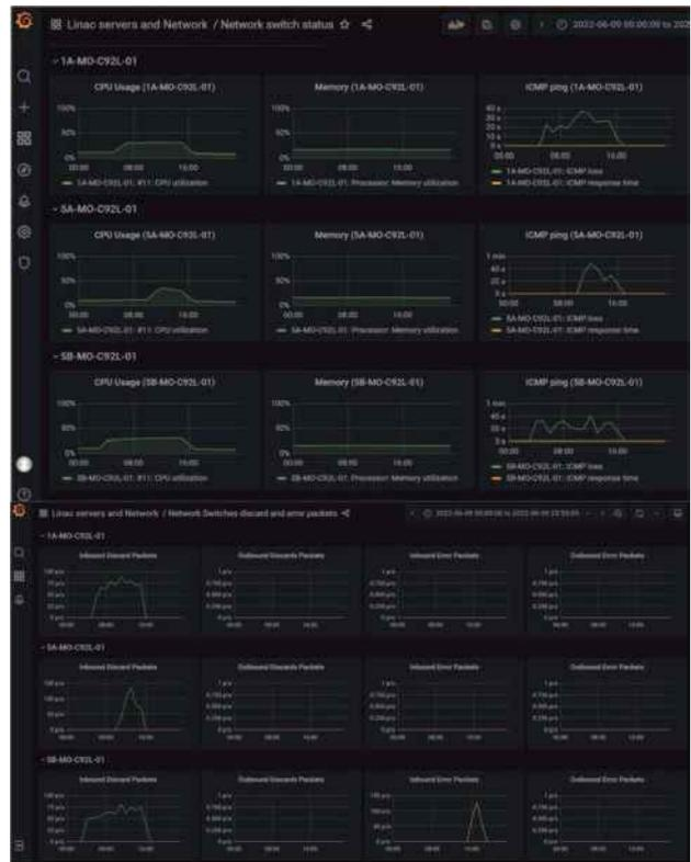
図 9: エッジスイッチ接続不良発生時のエッジスイッチ監視情報を示す Grafana のダッシュボード画面
