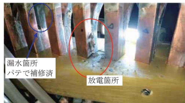
図 8: 放電発生後のロウ付け部分
