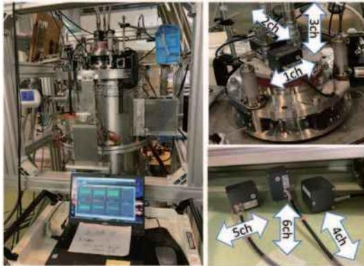
図 13: 加速度計による振動測定
