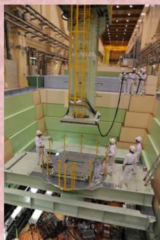
標的の遠隔操作による輸送(上) 標的輸送用カスクの制御画面(下)
