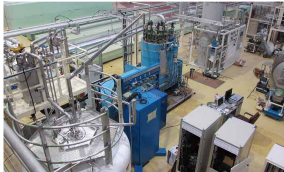
cERL の超伝導加速空洞のための液体ヘリウム冷凍機システム
