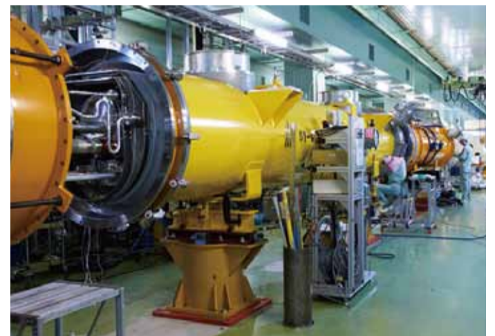
建設中の超伝導加速空洞
