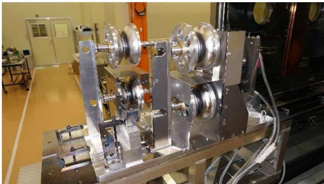
多ダンベル溶接ジグ 9セル空洞の中央部（ダンベル）の アイリス部（くびれ部）の溶接など
