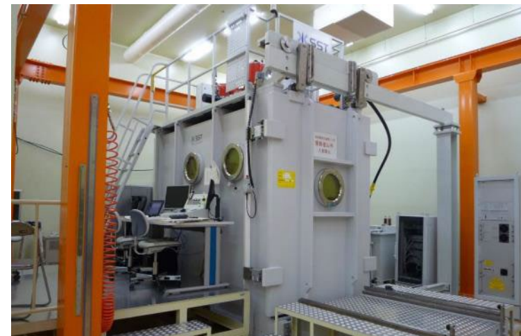
電子ビーム溶接機 (EBW室)_2011/4
